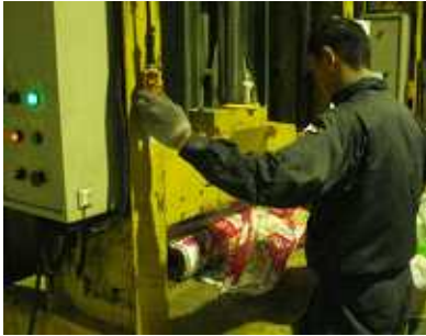
ハイパワーなギロチンカッターで、太いロールもバリバリ裁断。
