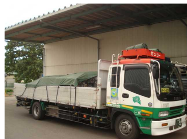
ラミフィルム搬入のトラック。幌をかけ、飛散がないよう注意を払っています。
